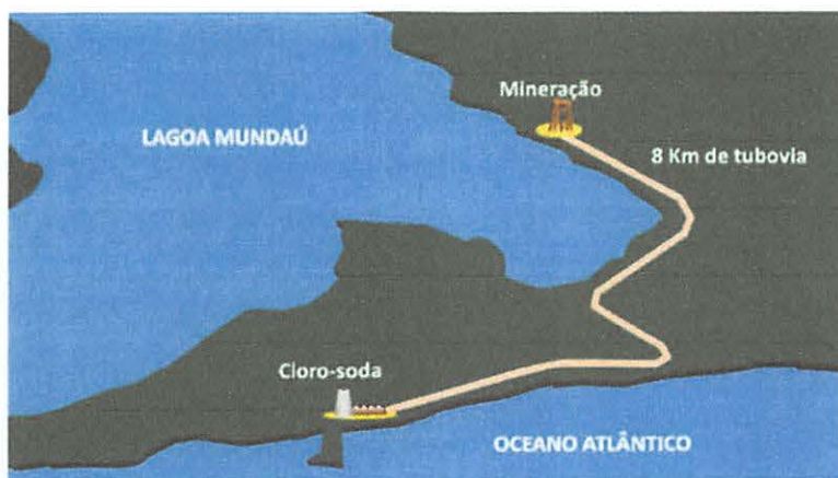
Figura 7- Dutovia ou salmouroduto. A salmoura extraída é bombeada da área da mina à planta de cloro-soda.
